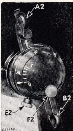
Afb. 42. Machine ingesteld voor recht stikken met stuitschroeven vastgezet.
