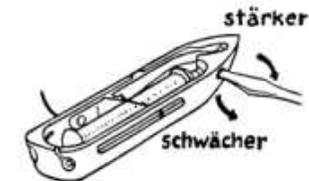
Einstellung der Fadenspannung am Schiffchen
