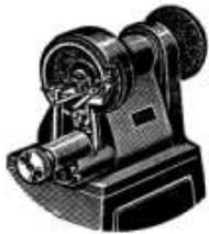
Schleifmaschine für Messer von Schneideeinrichtungen an Industriemaschinen (Tewes)
