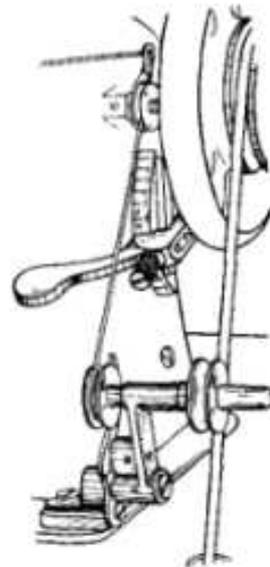
Klappenspuler für eintourige Umlaufgreifernähmaschinen
