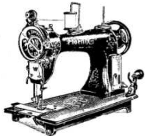
Schnellnäher mit ungleichförmig umlaufendem Fadenregler und einmal je Stich umlaufendem Greifer, ohne Brille (System Phoenix)
