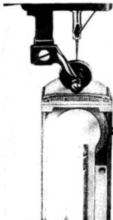
Schubradantrieb bei einer Säulenmaschine
