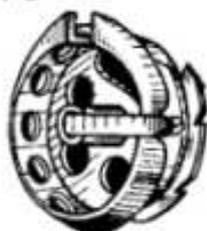
Spulengehäuse-Ausführung bei zweiteiligem brillenlosem Umlauf-Greifer nach W. & W. 11
