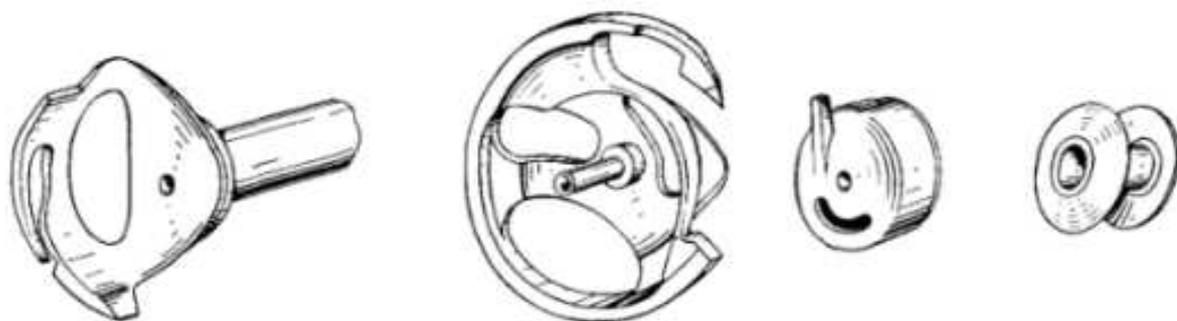
Umlaufender Ringgreifer mit Treiber, Spulenkapsel und Spule W. & W. 12 seit 1885.
