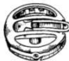
Das erste abziehbare Spulengehäuse für Umlaufgreifer von Mundlos 1902
