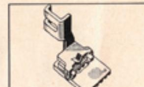
**Rollenfuss** für die verschiedensten Näh- und Zierarbeiten hauptsächlich auf plastischem Material, dicken Stoffrändern und zum Verbinden dehnbarer und gleitender Stoffe.
