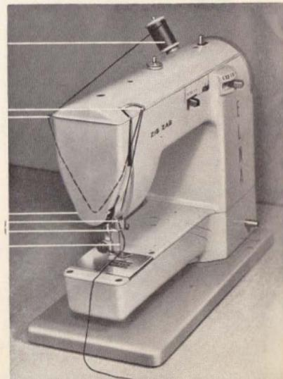
Gleiches Vorgehen beim Einfädeln der Maschine für Zwillingnadel (Spezialzubehör, siehe Seite 21). Den zweiten Spulenträger herausziehen. Beidseitig der Trennscheibe und durch jedes Nadelöhr ist ein Faden zu ziehen (Abb. 24 und 25).
